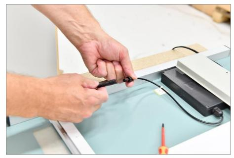
Débrancher le connecteur qui sépare la barre LED et l'alimentateur.
